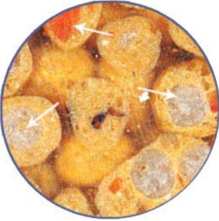
شكل (9) يوضح عدم تجانس مكونات السماد داخل الحبيبات
