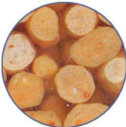
شكل (8) يوضح جنانس مكونات السماد داخل الحبيبات
